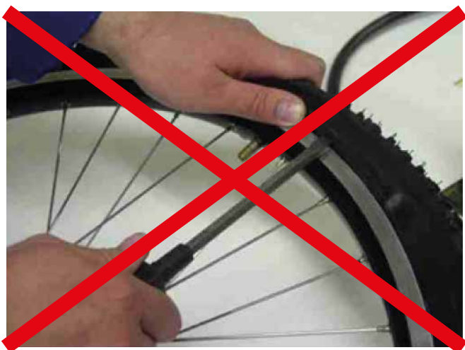
NIEPRAWIDŁOWY MONTAŻ / DEMONTAŻ
