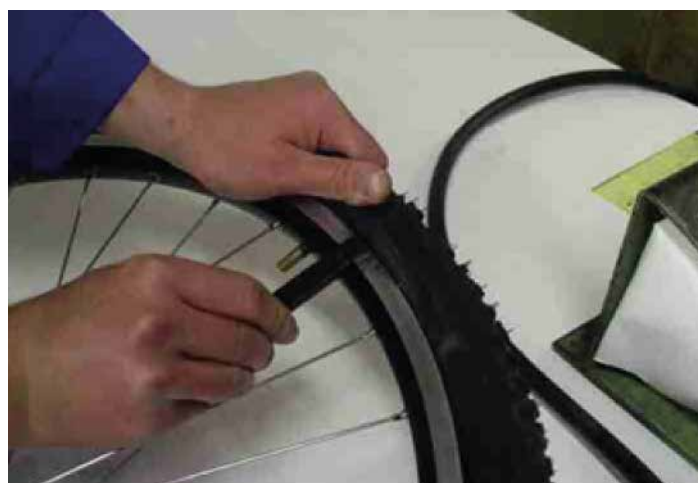
PRAWIDŁOWY MONTAŻ / DEMONTAŻ
